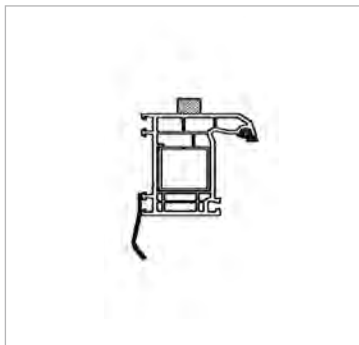
4. Наклеить по периметру внутреннюю пароизоляционную ленту
