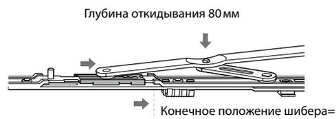
Ножницы 350 и 500 – Глубина откидывания 80 мм
