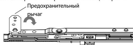
Ножницы 250 – Глубина откидывания 80 мм
