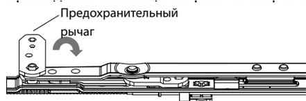
Ножницы 250 – Глубина откидывания 140 мм
