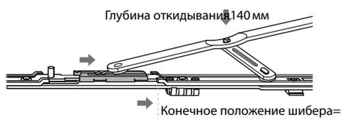
Ножницы 350 и 500 – Глубина откидывания 140 мм
